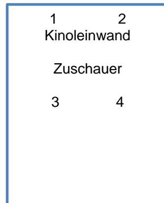
**5 Kanäle** - Als Erweiterung zur Quadrofonie wird bei dieser Variante ein neuer Kanal eingeführt. Ebenso wie bei der 3-Kanal-Variante wird ein zusätzlicher Lautsprecher zentral montiert und gibt beispielsweise nur die Dialoge eines Films wieder. Zudem sind hinter den Zuschauern noch zwei Lautsprecher angebracht, die das gleiche wiedergeben.
